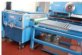
洗浄液によるシャワー洗浄と、ブラシによるブラッシング洗浄で圧倒的な洗浄力を発揮。打抜き、切断などで発生する金属板のバリを高速で除去します。
