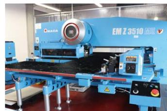
ACサーボモーターを動力源に、高速安定加工を実現。ヒットレートは従来仕様(油圧動力)の260[hpm]から、530[hpm]へと大幅UPしました。
